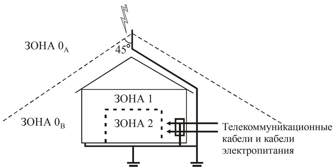
Рис. 3.6. Разделение защищаемого объекта на несколько зон.
