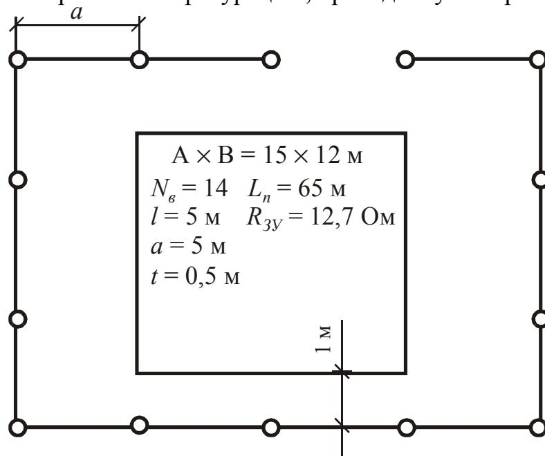
Рис. 1.15. План заземляющего устройства трансформаторной подстанции 10/0,23 кВ (к примеру 1.4).
