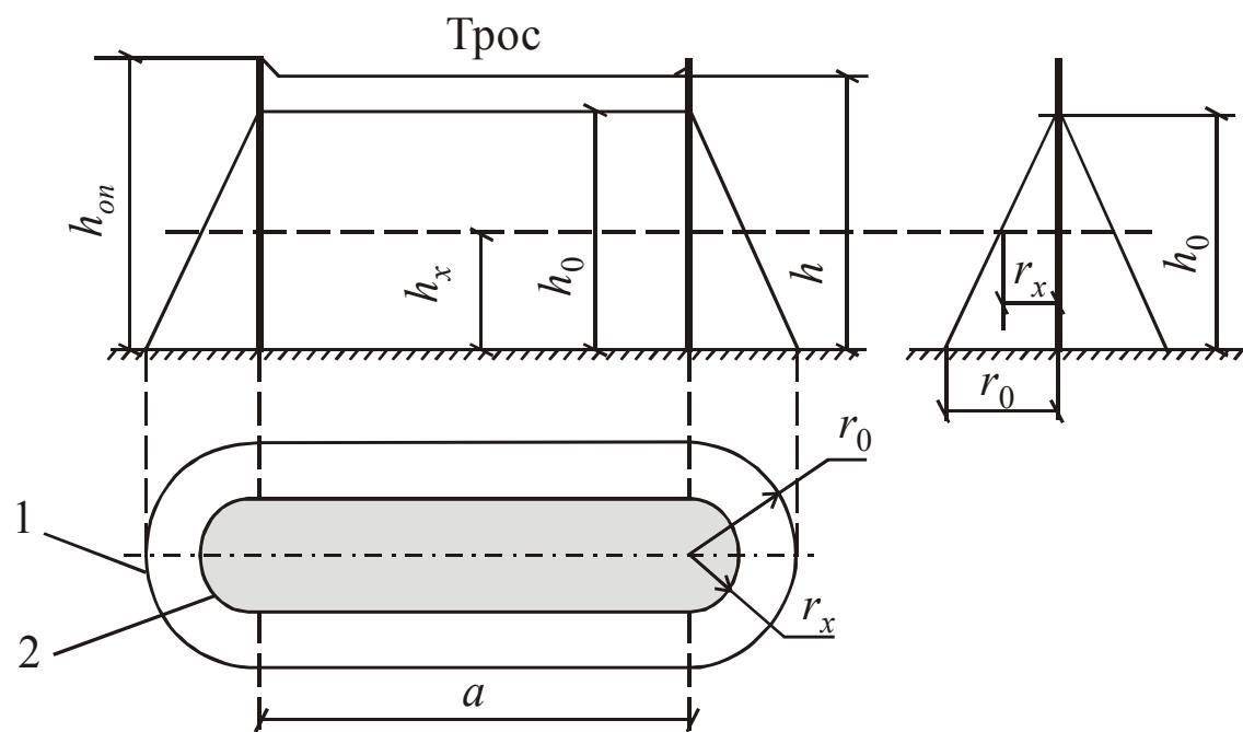
Рис. 1.8. Зона защиты одиночного тросового молниеводо-да: 1 – граница зоны на уровне земли; 2 – то же на уровне  $h_x$ .
