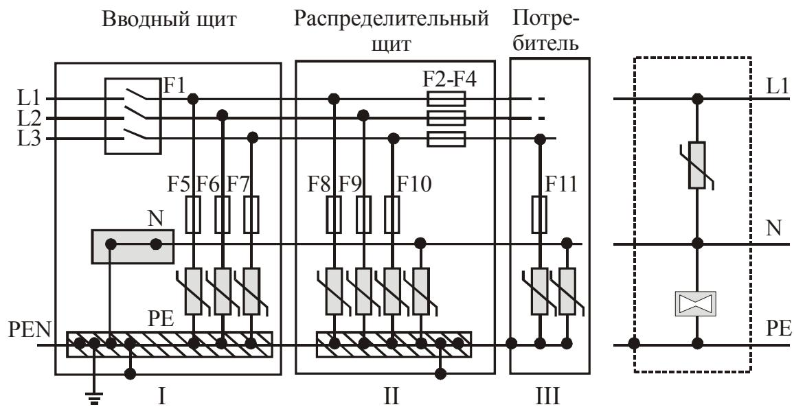
Рис. 3.9. Установка УЗИП в сети TN-C-S 220/380 В
