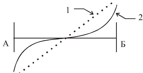
Рис. 4.7. Эпюры напряжения вдоль заземлителя, связывающего конструкции
