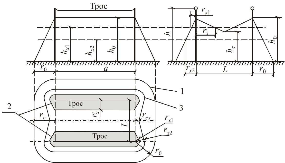
Рис. 1.9. Зона защиты двойного тросового молниеводоуда: 1 – граница зоны защиты на уровне земли; 2 – то же на уровне  $h_{x1}$ ; 3 – то же на уровне  $h_{x2}$ .
