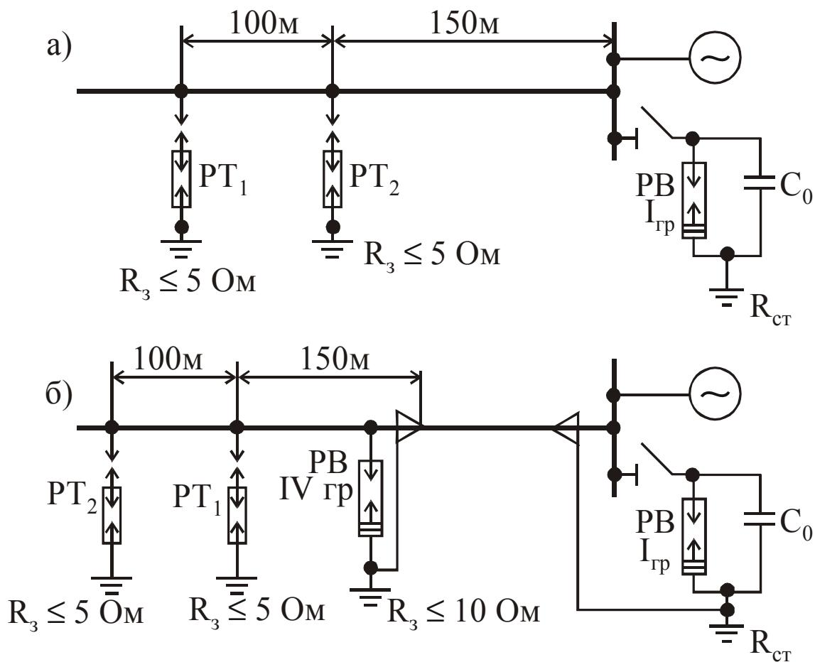
Рис. 1.21. Защита электрических машин мощностью менее 3 МВА.
