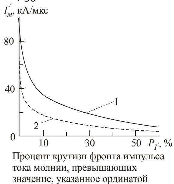
Рис. 1.2. Вероятностное распределение крутизны фронта импульса тока молнии: 1 – для равнинных районов; 2 – для горных районов.
