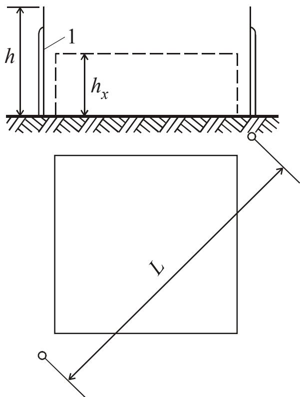
Рис. 1.3. Схема расположения отдельно стоящих молниеотводов открытого распределительного устройства: 1 – молниеотвод;  $h$  – высота молниеотвода;  $h_x$  – высота опорных конструкций подстанции;  $L$  – расстояние между молниеотводами.
