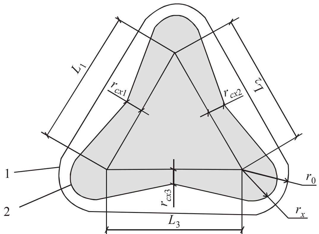
Рис. 1.7. Зона защиты (в плане) многократного стержневого молниеводо-да: 1 – граница зоны защиты на уровне земли; 2 – то же на уровне  $h_x$ .
