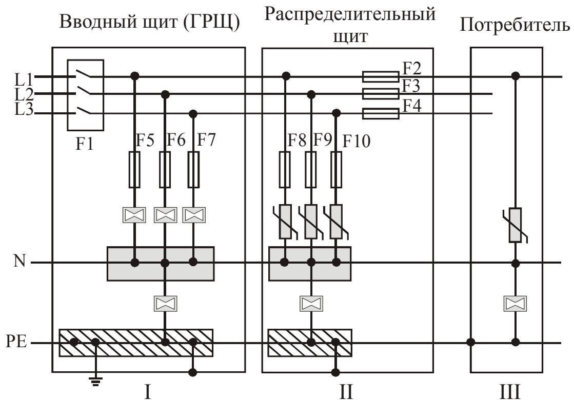
Рис. 3.10. Вариант установки УЗИП в сети TN-S
