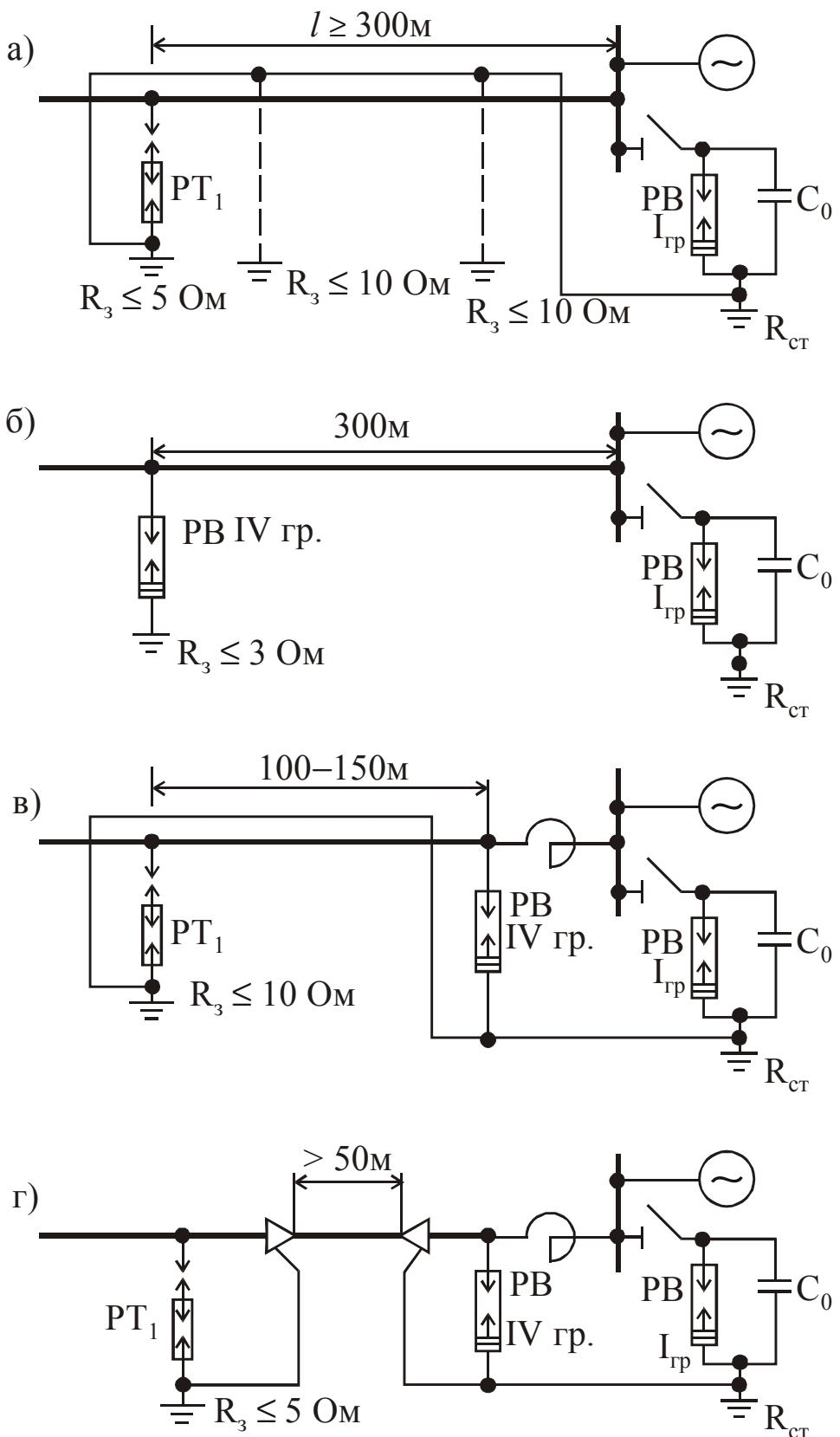
Рис. 1.20. Молниезащита подходов к подстанциям с электрическими машинами.
