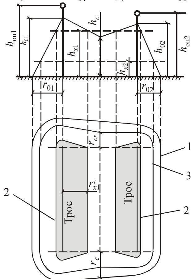
Рис. 1.10. Зона защиты двух тросовых молниеводоудов разной высоты: 1 – граница зоны защиты на уровне земли; 2 – то же на уровне  $h_{x1}$ ; 3 – то же на уровне  $h_{x2}$ .
