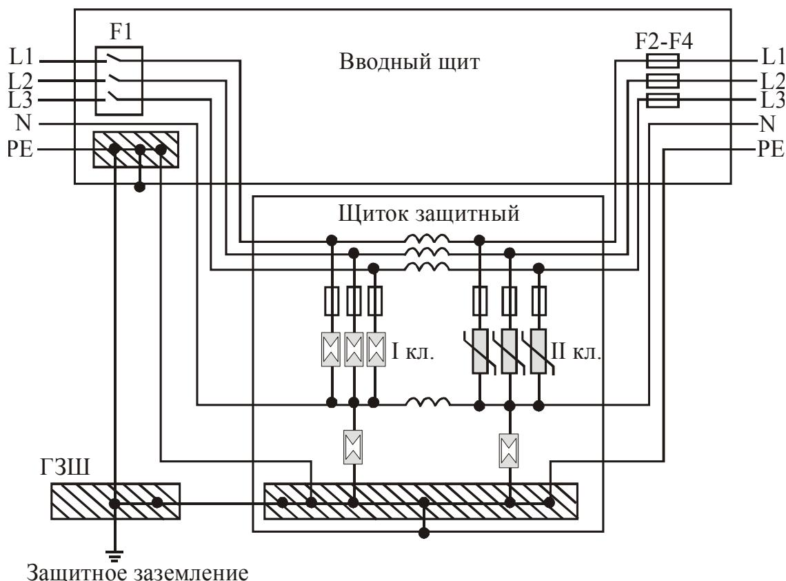
Рис. 3.12. Установка защитного щитка в трехфазную TN-S сеть
