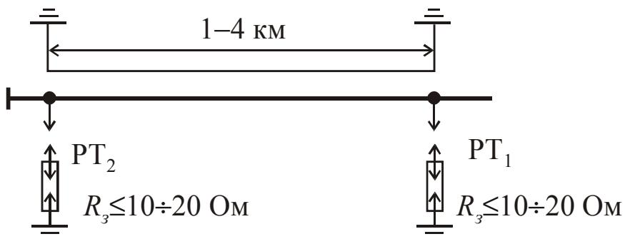
Рис. 1.17. Молниезащита подходов ВЛ напряжением 35 кВ и выше.
