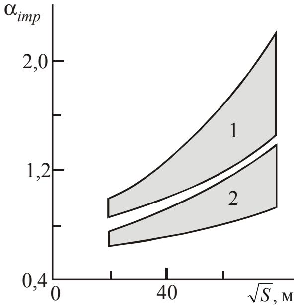
Рис. 1.13. Значения импульсного коэффициента для заземлителей в виде сеток ( $\rho=100\text{--}600 \Omega\cdot\text{м}$ ): зона 1 –  $I_m=10 \text{ кA}$ ; зона 2 –  $I_m=100 \text{ кA}$ .
