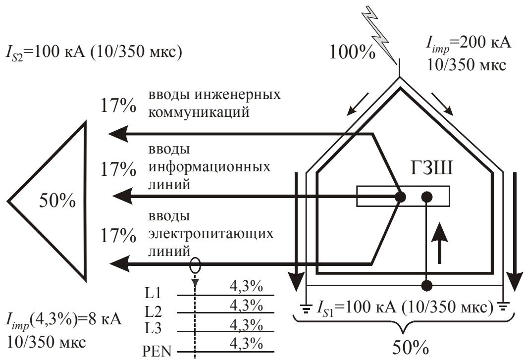
Рис. 3.14. Распределение токов молнии при прямом ударе в объект связи.
