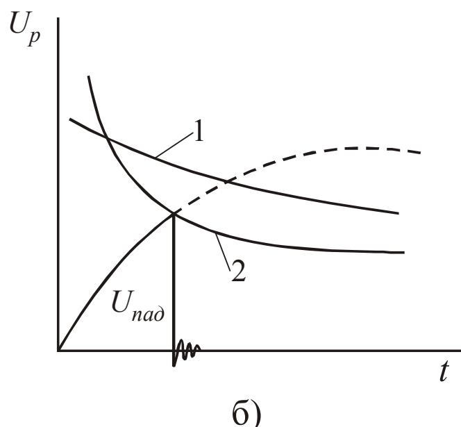
Рис. 2.1. Принцип действия защитного устройства: а) – схема включения защитного промежутка (ПЗ); б) – согласование вольтсекундных характеристик защищаемой изоляции (1) и защитного промежутка (2).
