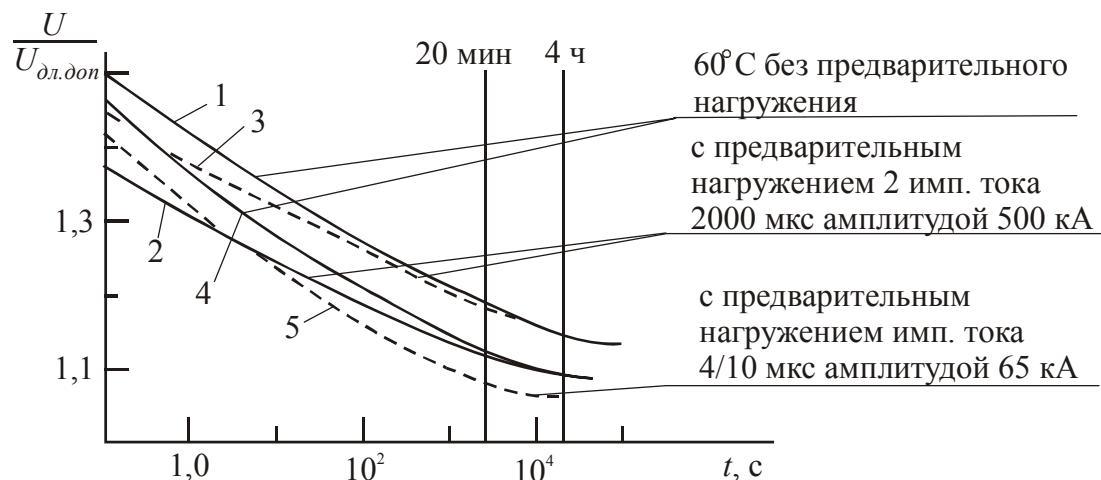
Рис. 2.7. Допустимое время приложения к ОПН напряжения промышленной частоты: 1, 2 – серия ОПН-П1(2) на 110 кВ; 2, 3 – серия ОПН-П1 от 3 до 35 кВ; 4, 5 – серия ОПН-1(2) от 3 до 10 кВ и серия ОПНФ на 6, 10 кВ.
