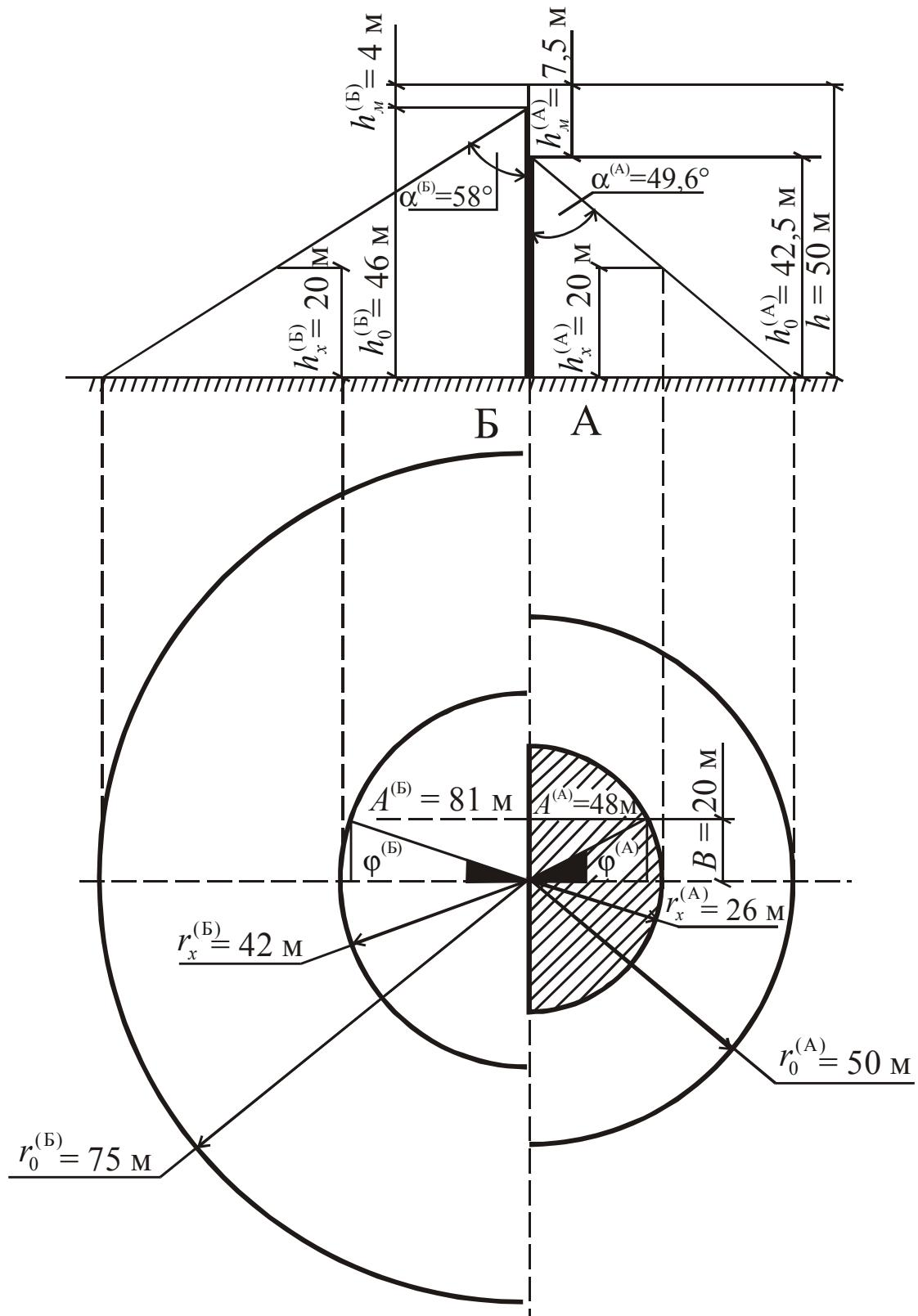
Рис. 1.11. Зоны защиты одиночного стержневого молниеводоа,  $h = 50 \text{ м}$ .
