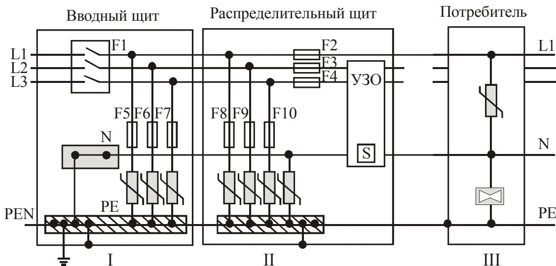
Рис. 3.15. Установка защитных устройств в TN-C-S сети 220/380 В.
