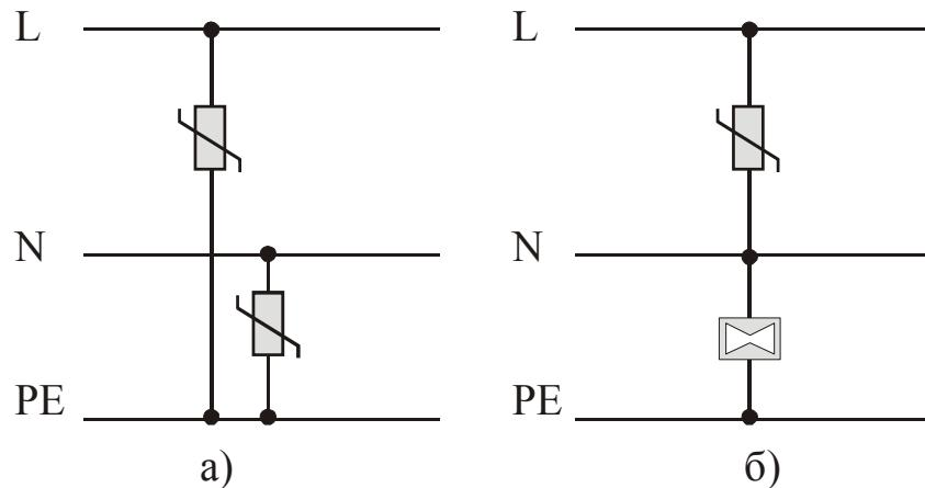
Рис. 3.8. Схемы защиты от перенапряжений:
