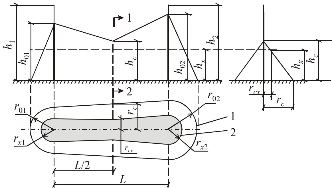
Рис. 1.6. Зона защиты двух стрежневых молниеводоудов разной высоты: 1 – граница зоны защиты на уровне земли; 2 – то же на уровне  $h_x$ .
