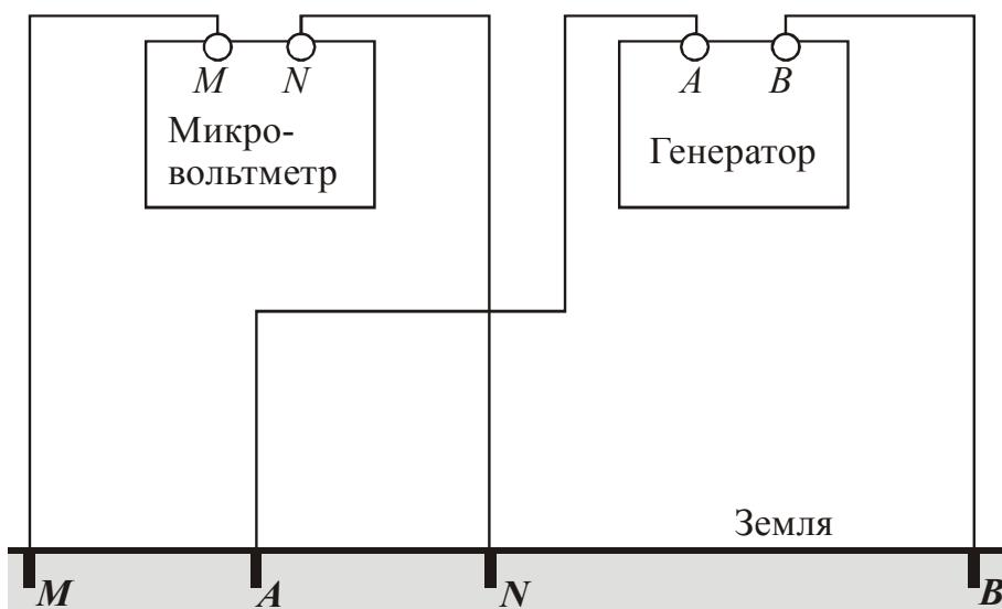
Рис. 4.1. Схема установки для вертикального электрического зондирования земли.
