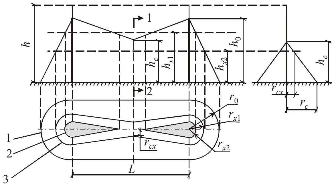
Рис. 1.5. Зона защиты двойного стержневого молниеводоуда высотой до 150 м:
