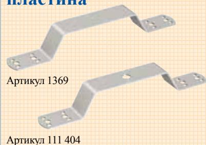
**Гибкий соединитель.** Для соединения металлических частей между собой (16 мм<sup>2</sup>). Можно использовать в качестве компенсатора. Биметаллические наконечники позволяют соединение меди с алюминием.
