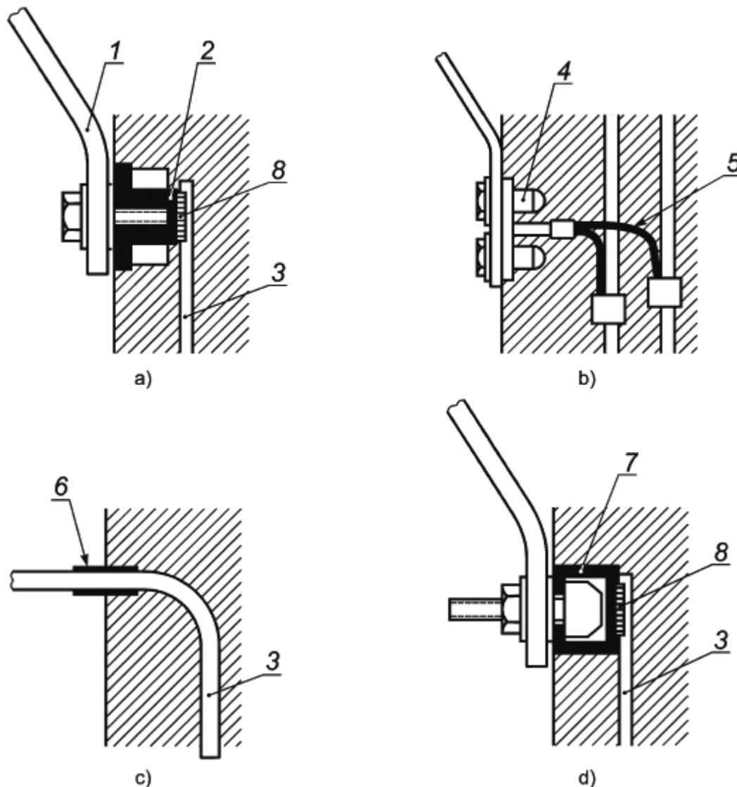
1 - проводник уравнивания потенциалов; 2 - гайка, приваренная к стальному проводнику уравнивания потенциалов; 3 - проводник уравнивания потенциалов, соединяющий со стальной арматурой\*; 4 - точка уравнивания потенциалов из цветного металла в бетоне; 5 - многопроволочный медный проводник уравнивания потенциалов; 6 - средство защиты от коррозии; 7 - С-образная стальная шина (С-образный монтажный кронштейн); 8 - сварка
