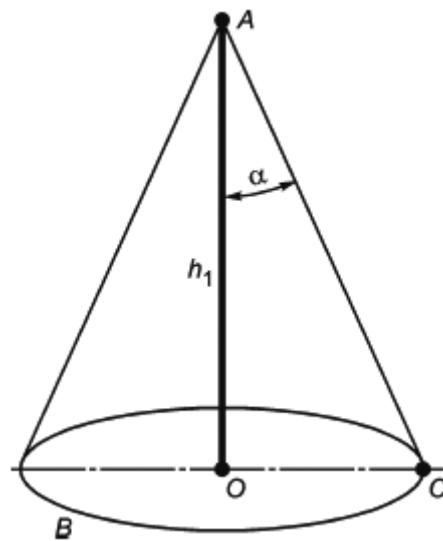
А - вершина стержневого молниеприемника; В - плоскость начала отсчета; ОС - радиус защищаемой зоны;  $h_1$  - высота стержневого молниеприемника над плоскостью начала отчета защищаемой зоны;  $\alpha$  - защитный угол (см. таблицу 2)
