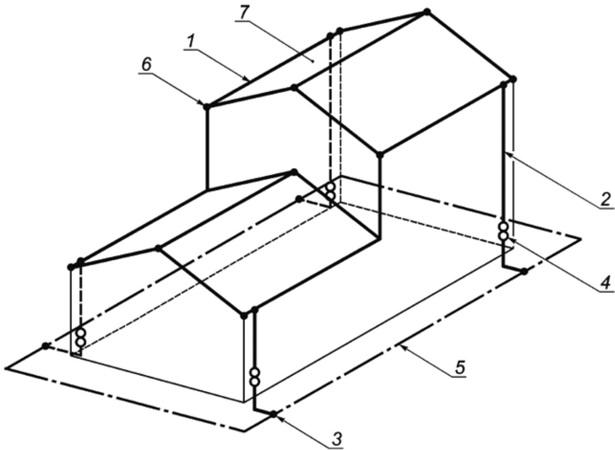
1 - горизонтальный проводник молниеприемника; 2 - токоотвод; 3 - Т-образное соединение, стойкое к коррозии; 4 - испытательный зажим; 5 - кольцевой заземлитель, заземляющее устройство конфигурации В; 6 - Т-образное соединение на гребне крыши; 7 - размер ячейки
