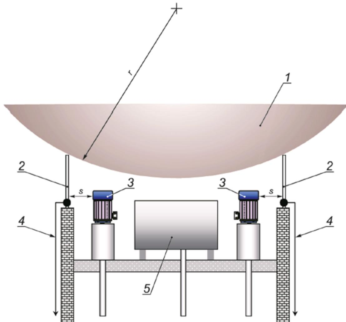
1 - катящаяся сфера; 2 - стержневой молниеприемник; 3 - электрическое оборудование; 4 - токоотвод; 5 - металлический резервуар;  $r$  - радиус катящейся сферы (см. таблицу 2);  $s$  - разделительное расстояние в соответствии с 6.3
