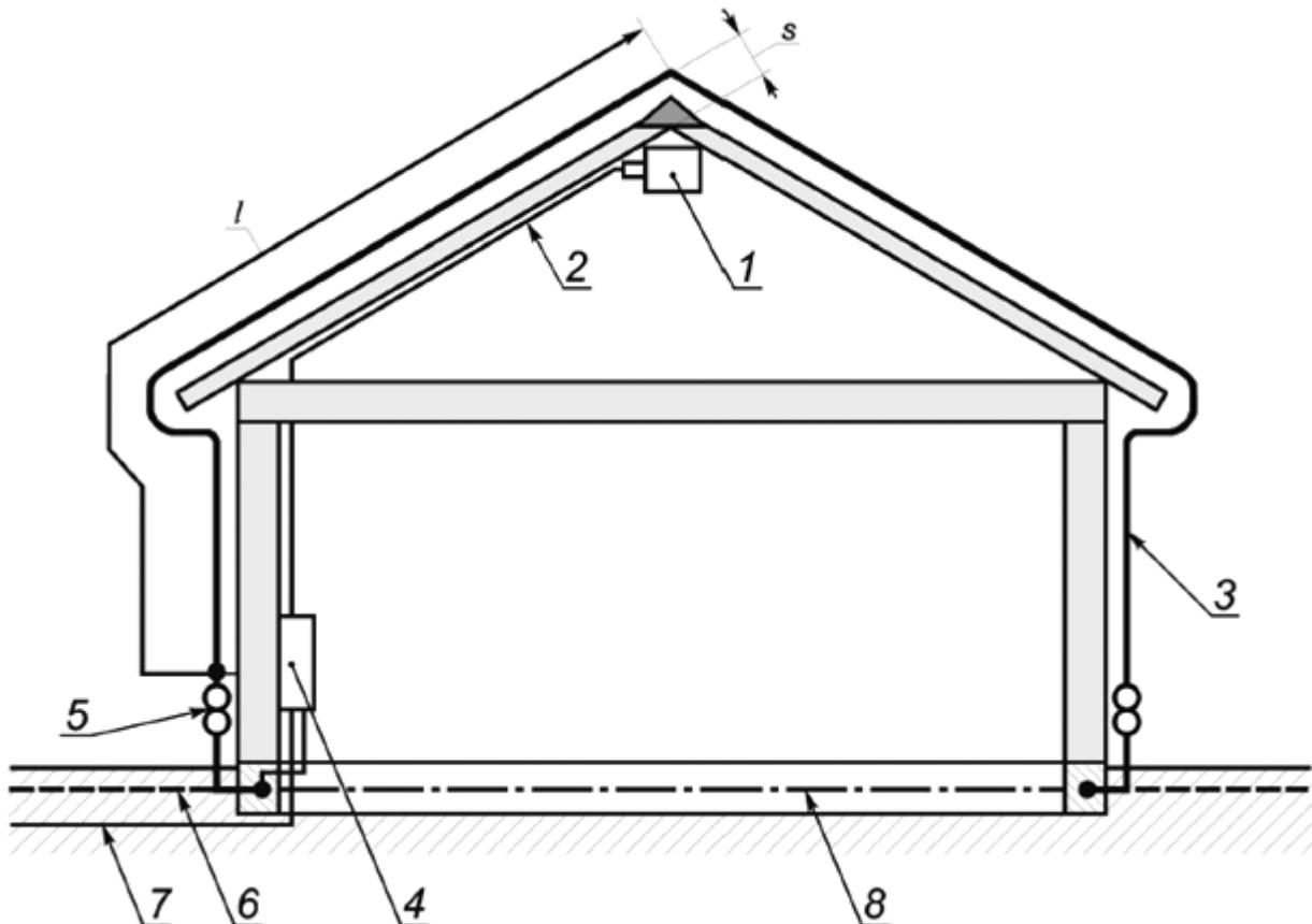
1 - электрическое оборудование; 2 - электрические проводники; 3 - проводники системы молниезащиты; 4 - главный электрический распределительный щит с устройством защиты от перенапряжений; 5 - испытательный зажим; 6 - заземляющее устройство; 7 - электрический силовой кабель; 8 - фундаментный заземлитель;  $s$  - разделительное расстояние в соответствии с 6.3; 1 - длина для расчета разделительного расстояния  $s$
