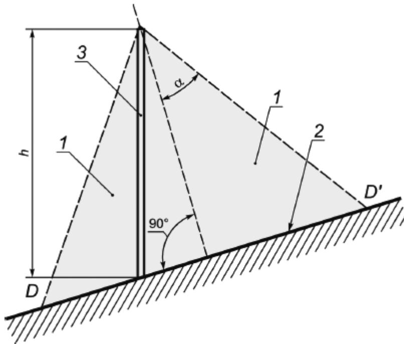
1 - защищаемый объем; 2 - плоскость начала отсчета; 3 - стержневой молниеприемник;  $h$  - значение высоты молниеприемника в соответствии с таблицей 2;  $\alpha$  - защитный угол;  $D, D'$  - граница защищенного объема
