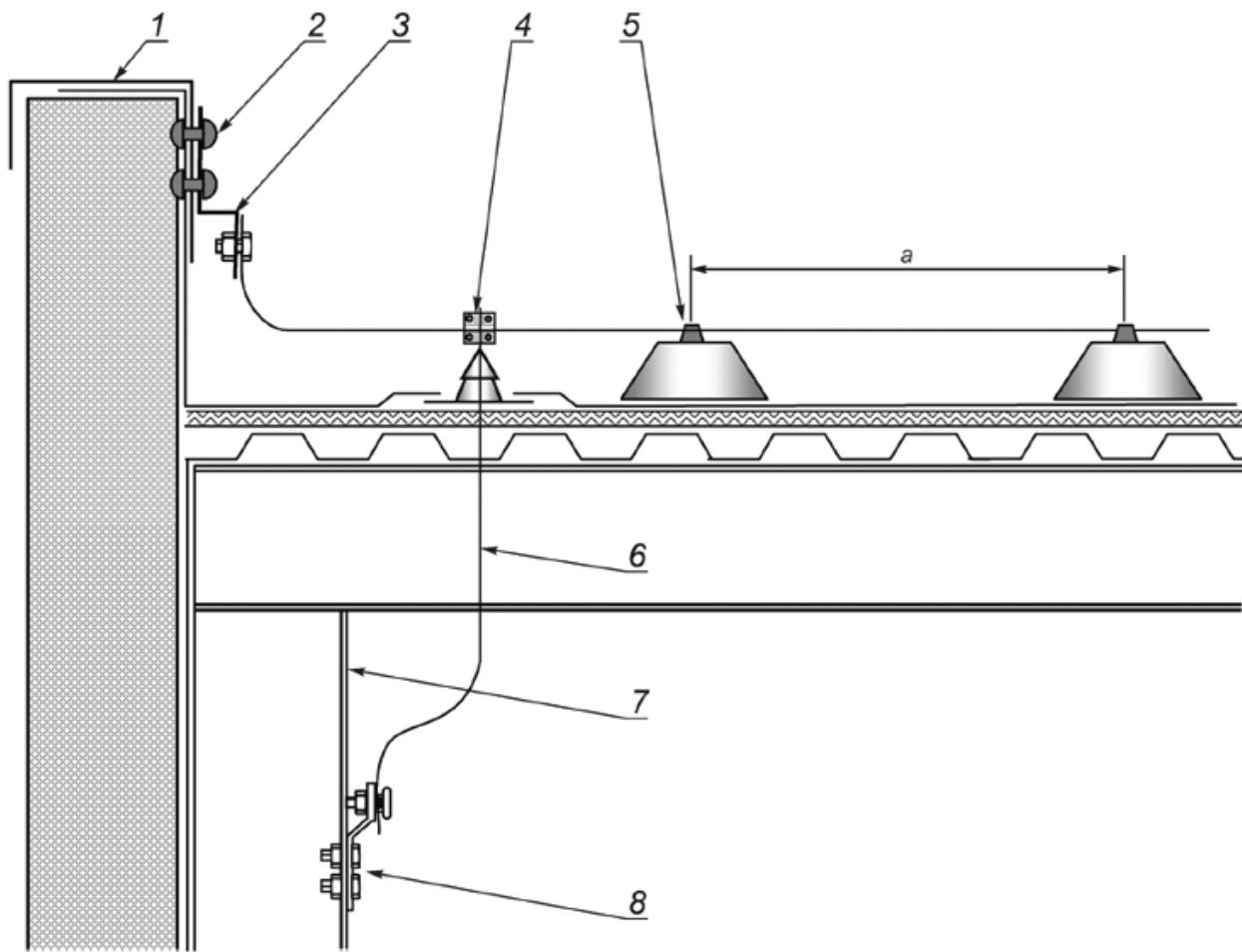
$\alpha$  - от 500 до 1000 мм (см. таблицу Е.1); 1 - парапет крыши; 2 - соединение; 3 - гибкий проводник; 4 - Т-образные соединения; 5 - крепление проводника молниеприемника; 6 - проход проводника системы молниезащиты через водонепроницаемую втулку; 7 - стальная колонна; 8 - соединение
