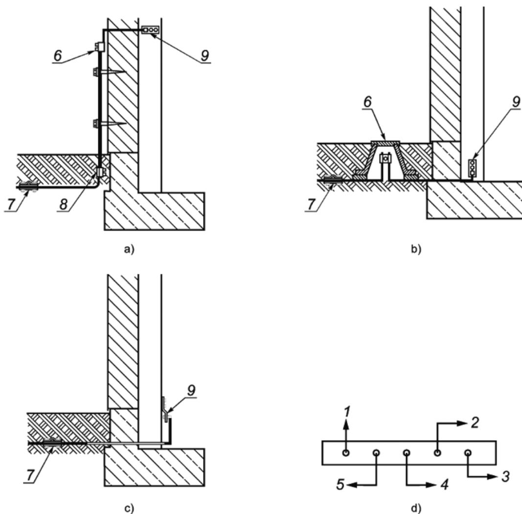
Вариант 1 — Испытательный зажим на стене
