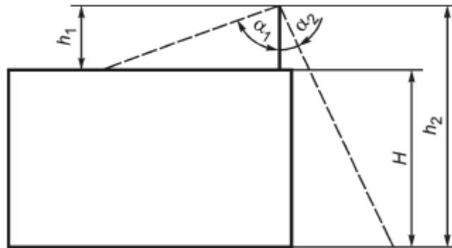
$h_1$  - физическая высота стержневого молниеприемника
