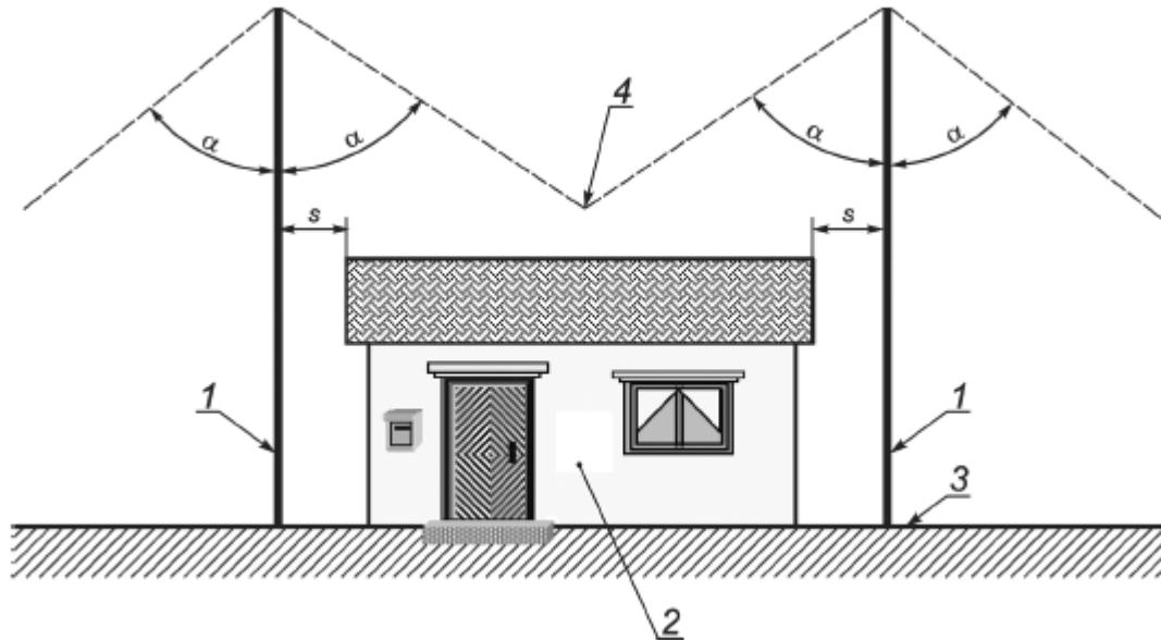
1 - стержневой молниеотвод; 2 - защищаемое сооружение; 3 - земля, являющаяся плоскостью начала отсчета; 4 - пересечение зоны защиты в виде конусов;  $s$  - разделительное расстояние в соответствии с 6.3;  $\alpha$  - угол защиты в соответствии с таблицей 2
