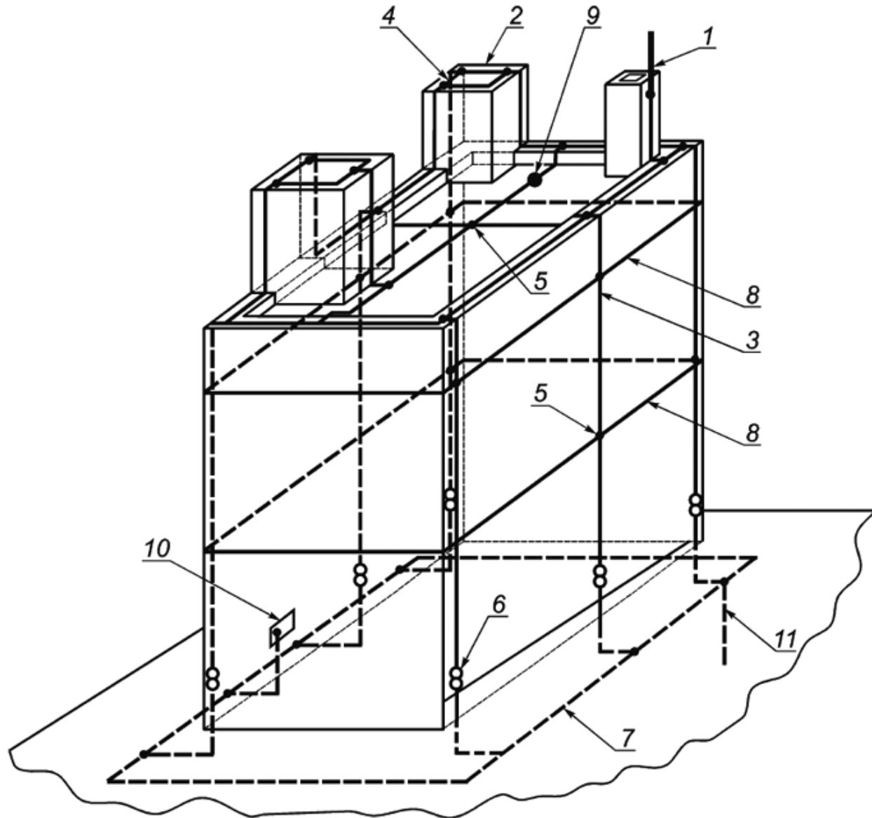
1 - стержневой молниеприемник; 2 - горизонтальный проводник молниеприемника; 3 - токоотвод; 4 - Т-образное соединение; 5 - крестообразное соединение; 6 - испытательный зажим; 7 - кольцевой заземлитель, заземляющее устройство конфигурации В; 8 - кольцевой проводник уравнивания потенциалов; 9 - плоская крыша и крепление проводника к крыше; 10 - зажим для подключения шины уравнивания потенциалов внутренней СМЗ; 11 - вертикальный заземлитель
