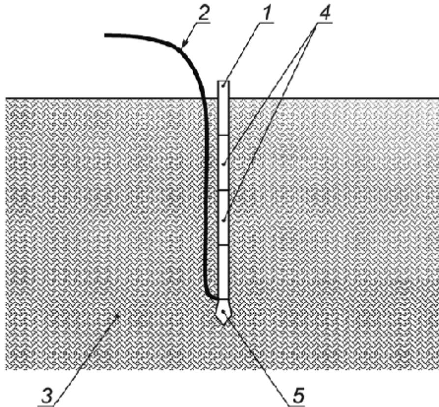
1 - короткий самый верхний отрезок заглубляемого стержня; 2 - проводник заземлителя; 3 - грунт; 4 - отрезки заглубляемого стержня; 5 - стальное острье
