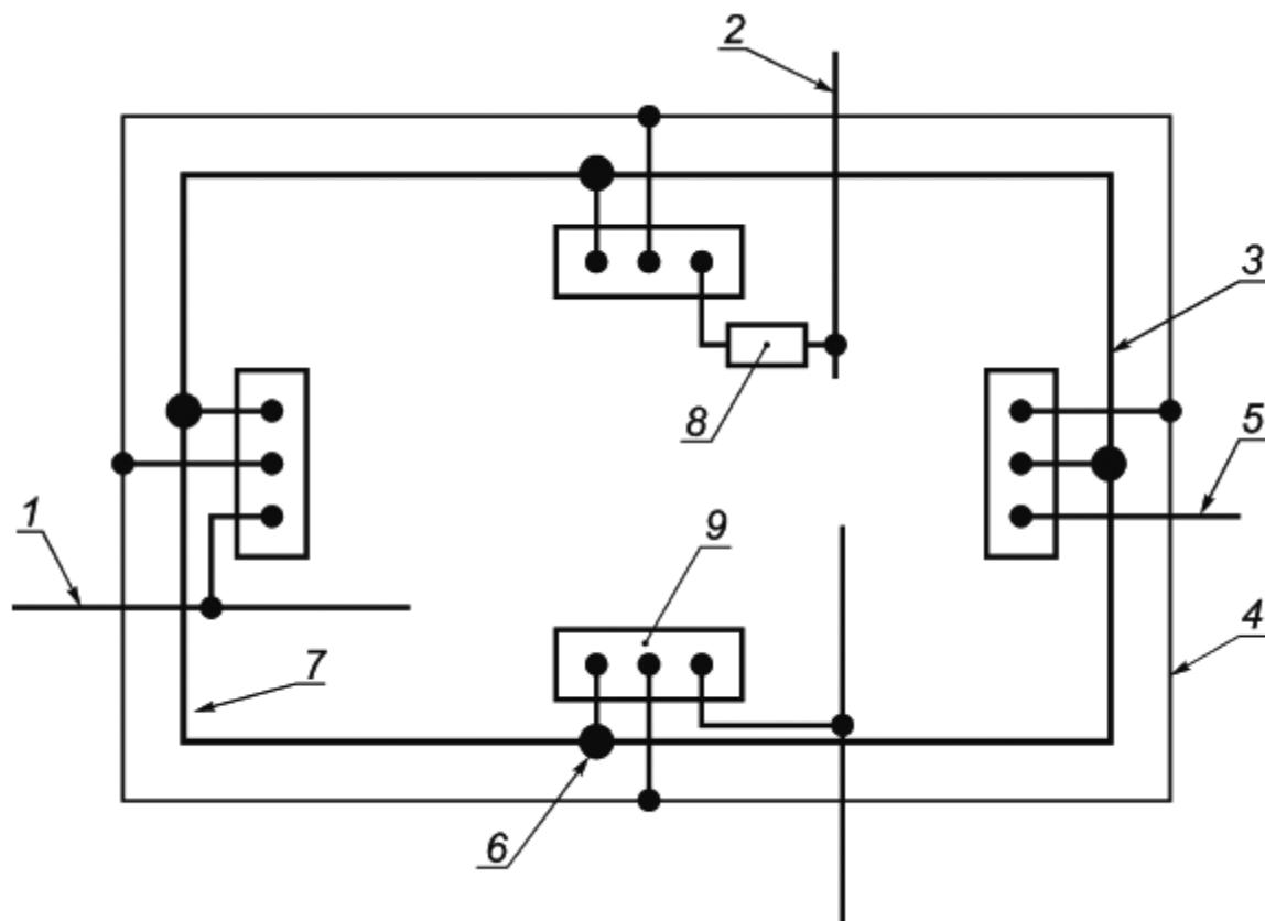
1 - внешняя проводящая часть, например металлическая водопроводная труба; 2 - линия электроснабжения или линия связи; 3 - стальная арматура внешней железобетонной стены и фундамента; 4 - кольцевой заземлитель; 5 - присоединение к дополнительному заземлителю; 6 - специальное соединение для уравнивания потенциалов; 7 - железобетонная стена; 8 - устройство защиты от перенапряжений; 9 - шина уравнивания потенциалов
