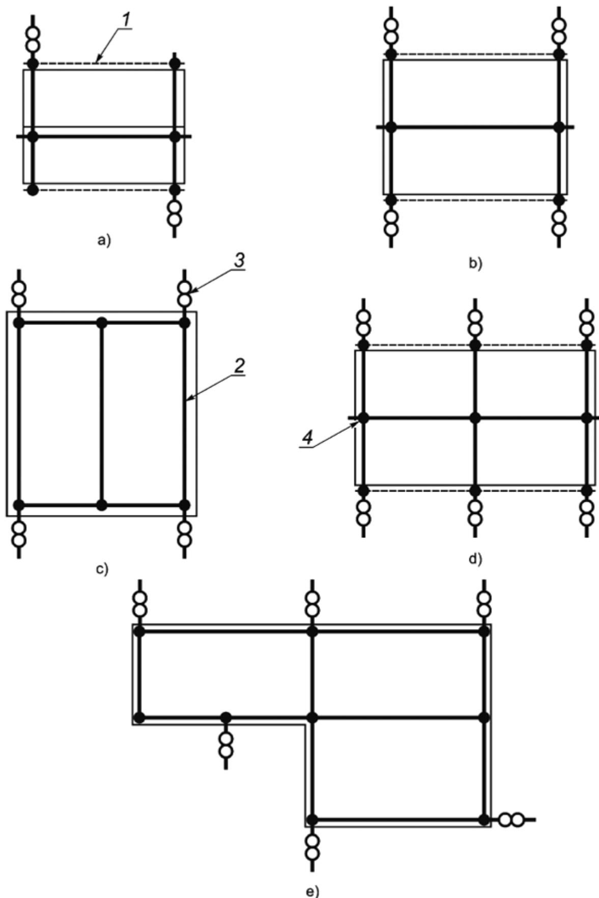
1 - естественные компоненты системы молниезащиты, например водостоки; 2 - проводники системы молниезащиты; 3 - испытательный зажим; 4 - соединение
