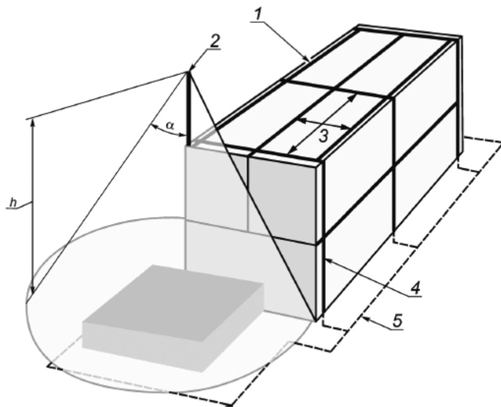
1 - проводник молниеприемной сетки; 2 - стержневой молниеприемник; 3 - размер ячейки; 4 - токоотвод; 5 - заземляющее устройство в виде кольцевого проводника;  $h$  - высота молниеприемника над уровнем земли;  $\alpha$  - защитный угол
