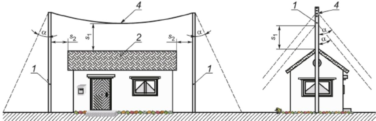
а) Вертикальное сечение плоскостью, включающей в себя молниеотводы
