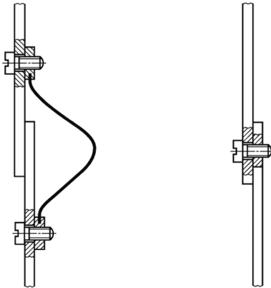
а) Перемычка гибкой металлической полосой
