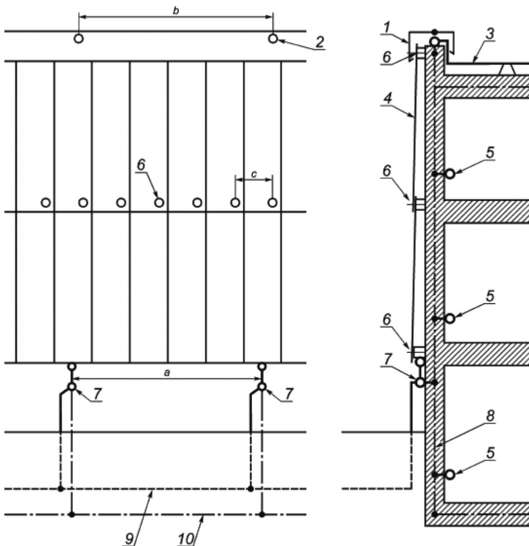
1 - металлический фартук парапета на крыше; 2 - соединение между фасадными панелями и молниеприемником; 3 - горизонтальный проводник молниеприемника; 4 - металлический сегмент фасадного покрытия; 5 - шина уравнивания потенциалов для внутренней СМЗ; 6 - соединение между фасадными панелями и опорной рамой; 7 - испытательный зажим; 8 - стальная железобетонная арматура; 9 - кольцевой заземлитель конфигурации В; 10 - фундаментный заземлитель
