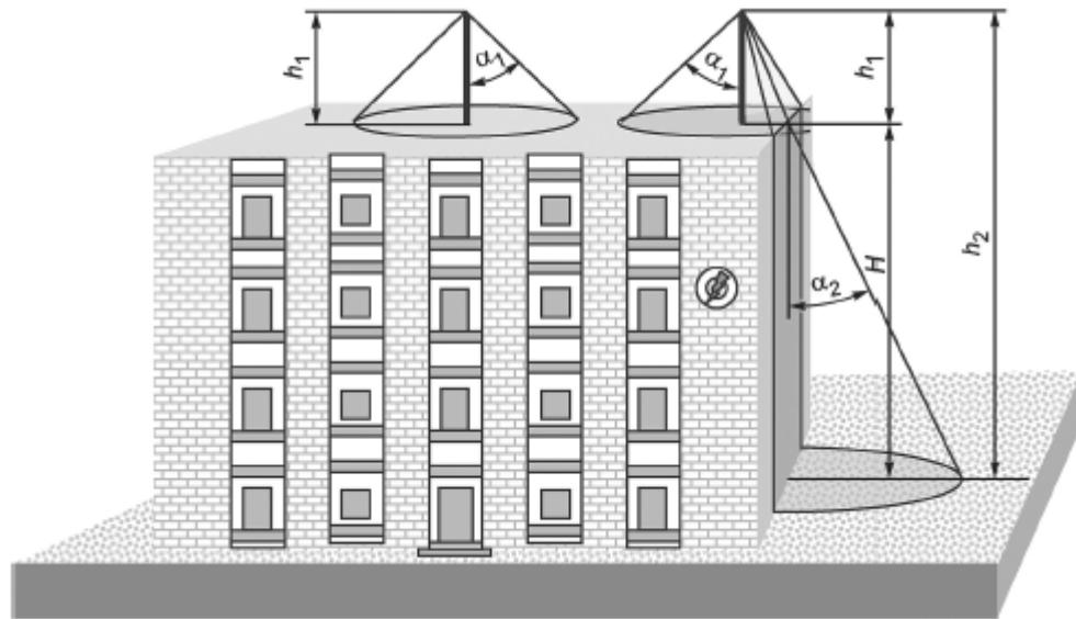
$H$  - высота здания над поверхностью земли;  $h_1$  - физическая высота стержневого молниеприемника;
