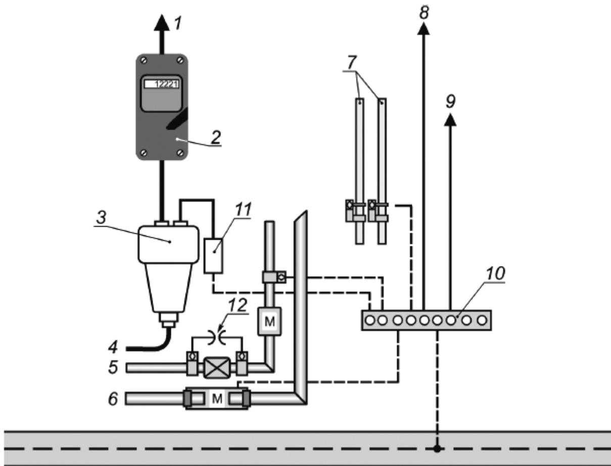
1 - ввод к потребителю электроэнергии; 2 - счетчик электроэнергии; 3 - входная клеммная коробка; 4 - ввод электроэнергии от питающей сети; 5 - газ; 6 - вода; 7 - система центрального отопления; 8 - к электронным устройствам; 9 - к экрану кабеля антенны; 10 - шина уравнивания потенциалов; 11 - устройство защиты от перенапряжений; 12 - разделительный искровой разрядник; М - счетчик
