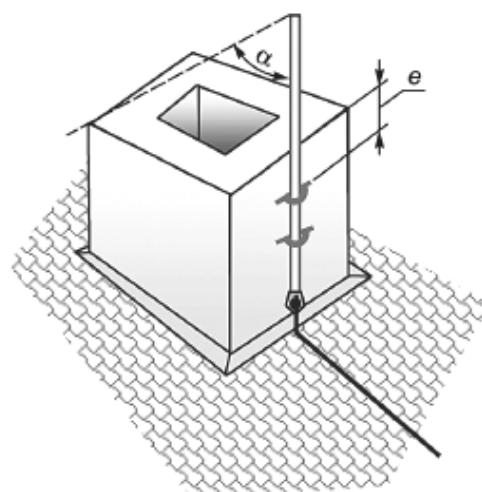
б) Установка стержневого молниеприемника для защиты дымовой трубы с расчетом молниеприемника по методу защитного угла
