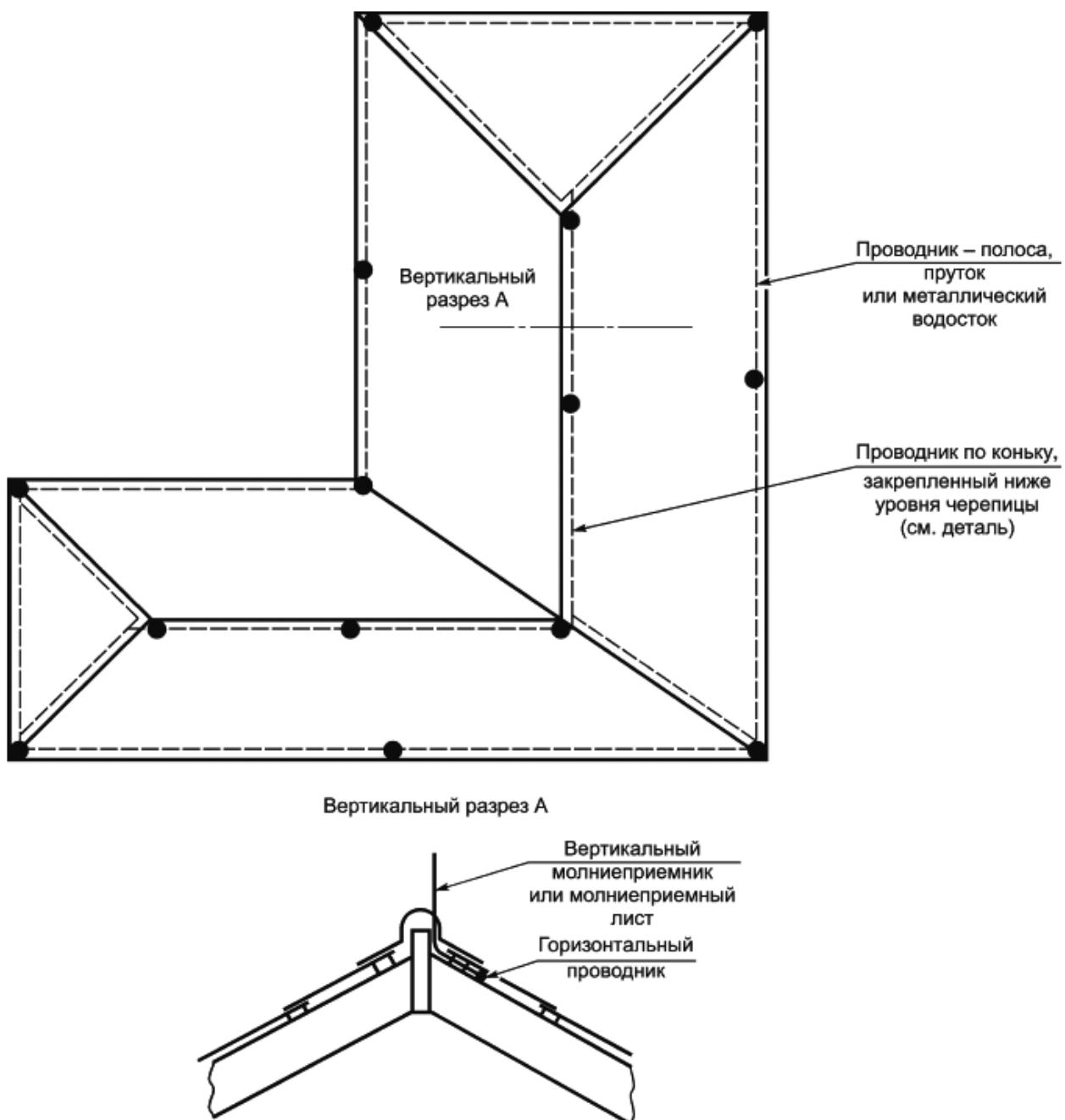
Рисунок Е.23 - Молниеприемник и скрытые проводники для сооружений высотой менее 20 м со скатными крышами
