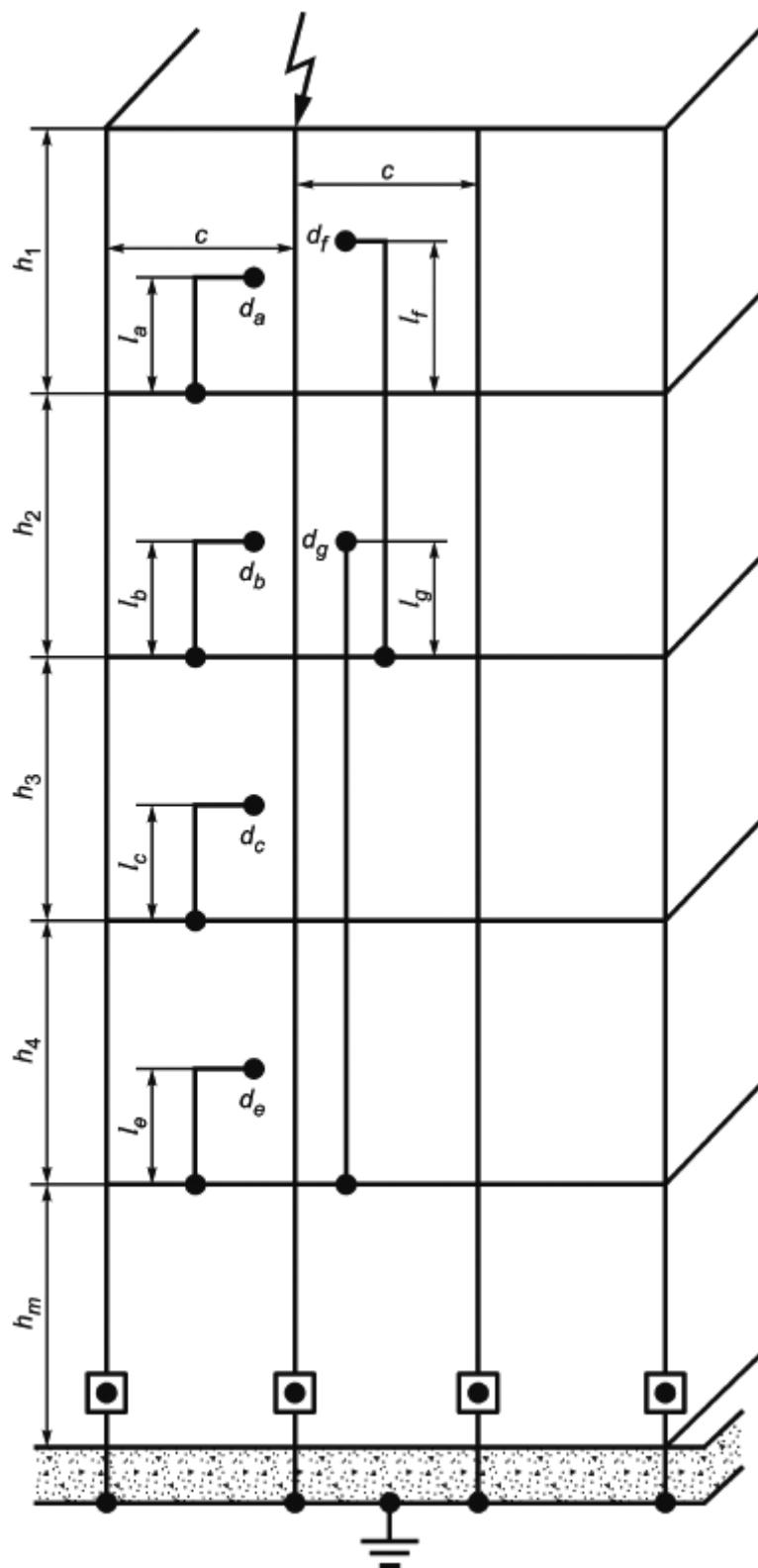
$n$  - общее число токоотводов;  $c$  - расстояние между токоотводами;  $h$  - расстояние (по высоте) между кольцевыми проводниками;  $m$  - общее число уровней;  $d$  - расстояние до ближайшего токоотвода;  $l$  - высота над точкой уравнивания потенциалов
