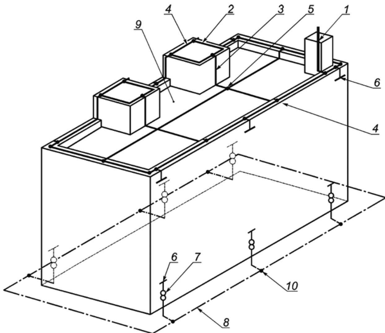
1 - стержневой молниеприемник; 2 - горизонтальный проводник молниеприемника; 3 - токоотвод; 4 - Т-образное соединение; 5 - крестообразное соединение; 6 - соединение со стальной арматурой железобетона (см. Е.4.3.3 и Е.4.3.6); 7 - испытательный зажим; 8 - кольцевой заземлитель, заземляющее устройство конфигурации В; 9 - плоская крыша и крепление проводника к крыше; 10 - Т-образное соединение, стойкое к коррозии
