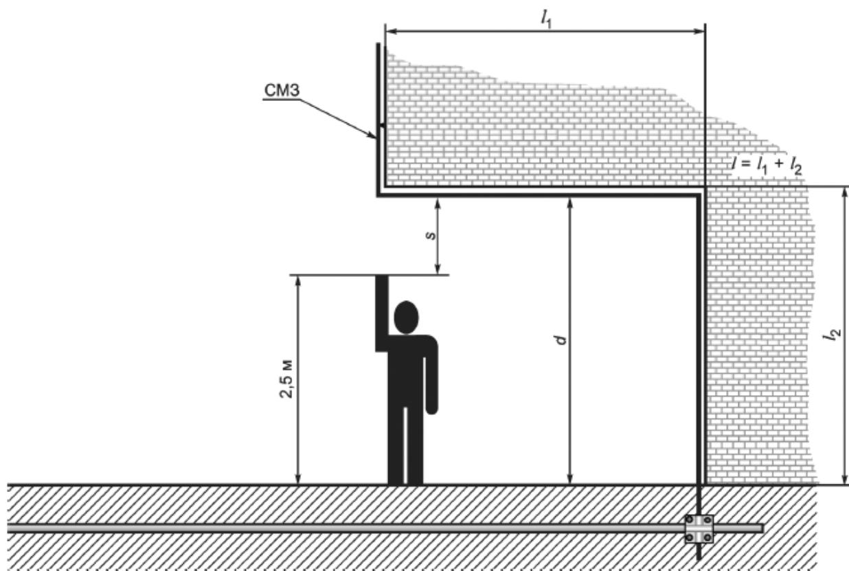
$d$  - фактическое расстояние более  $s$ ;  $s$  - разделительное расстояние, определяемое по формуле (4);  $l$  - длина для расчета разделительного расстояния  $s$
