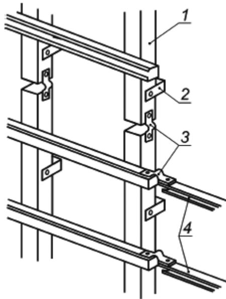
1 - вертикальные части каркаса; 2 - крепление к стене; 3 - соединители; 4 - горизонтальные части каркаса
