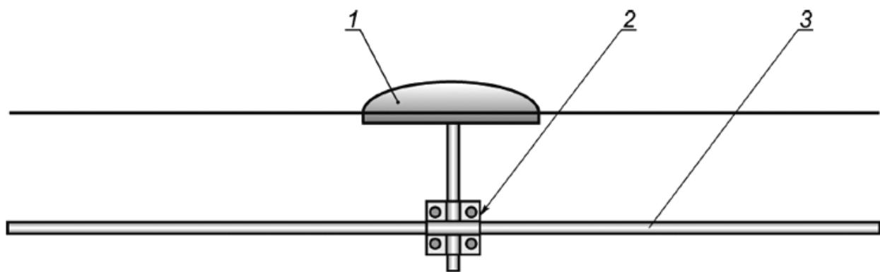
1 - молниеприемник в виде большой шляпки гвоздя; 2 - стальной проводник, соединенный с несколькими арматурными стержнями; 3 - арматура железобетона
